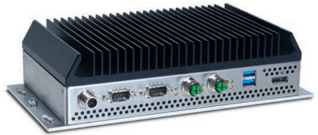
Der KI Railway Computer RSL A3 basiert auf dem Nvidia Jetson AGX Xavier. Er eignet sich für anspruchsvolle Inferenzanwendungen wie autonomes oder teilautonomes Fahren.
