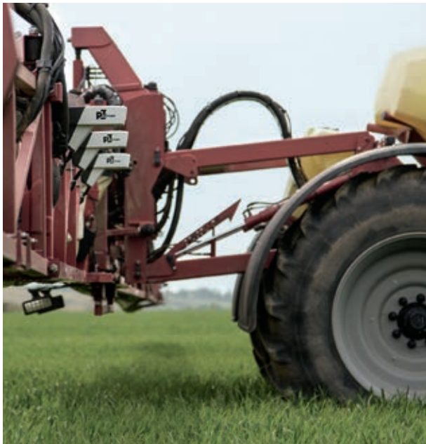
Drei Sensorköpfe am Spritzgestänge eines Pflanzenschutz-Sensorsystems.
