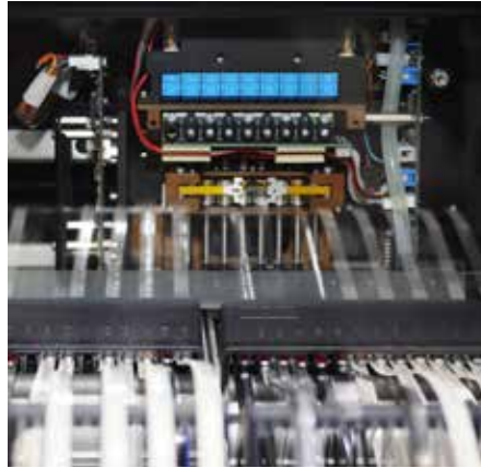
Syslogic fertigt ihre CPU-Boards mit eigener SMD-Bestückung.
